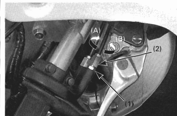
(1) ロックナット (2) アジャスタ (A) 遊びが少なくなる (B) 遊びが多くなる
