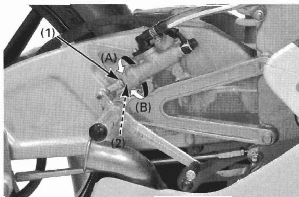
(1) ロックナット (2) アジャストボルト (A) ペダルが高くなる (B) ペダルが低くなる
