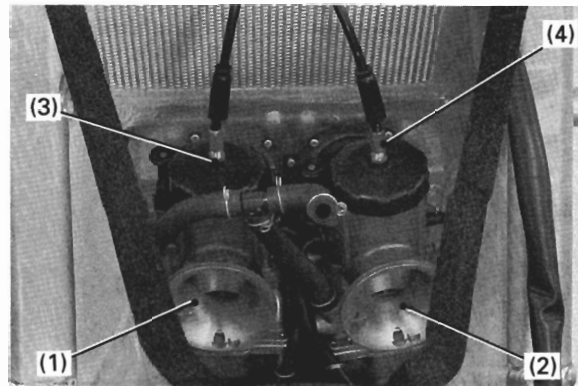
(1) No.1キャブレータ (2) No.2キャブレータ (3) ロックナット (4) アジャスタ
